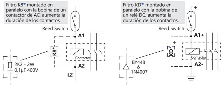
**? Riesgo de mal funcionamiento (soldadura en interruptor de láminas de contacto)** debido a la CAPACITANCIA, lo que puede ocurrir en función de la distancia y el cable que se utilice en la conexión con el contactor.
