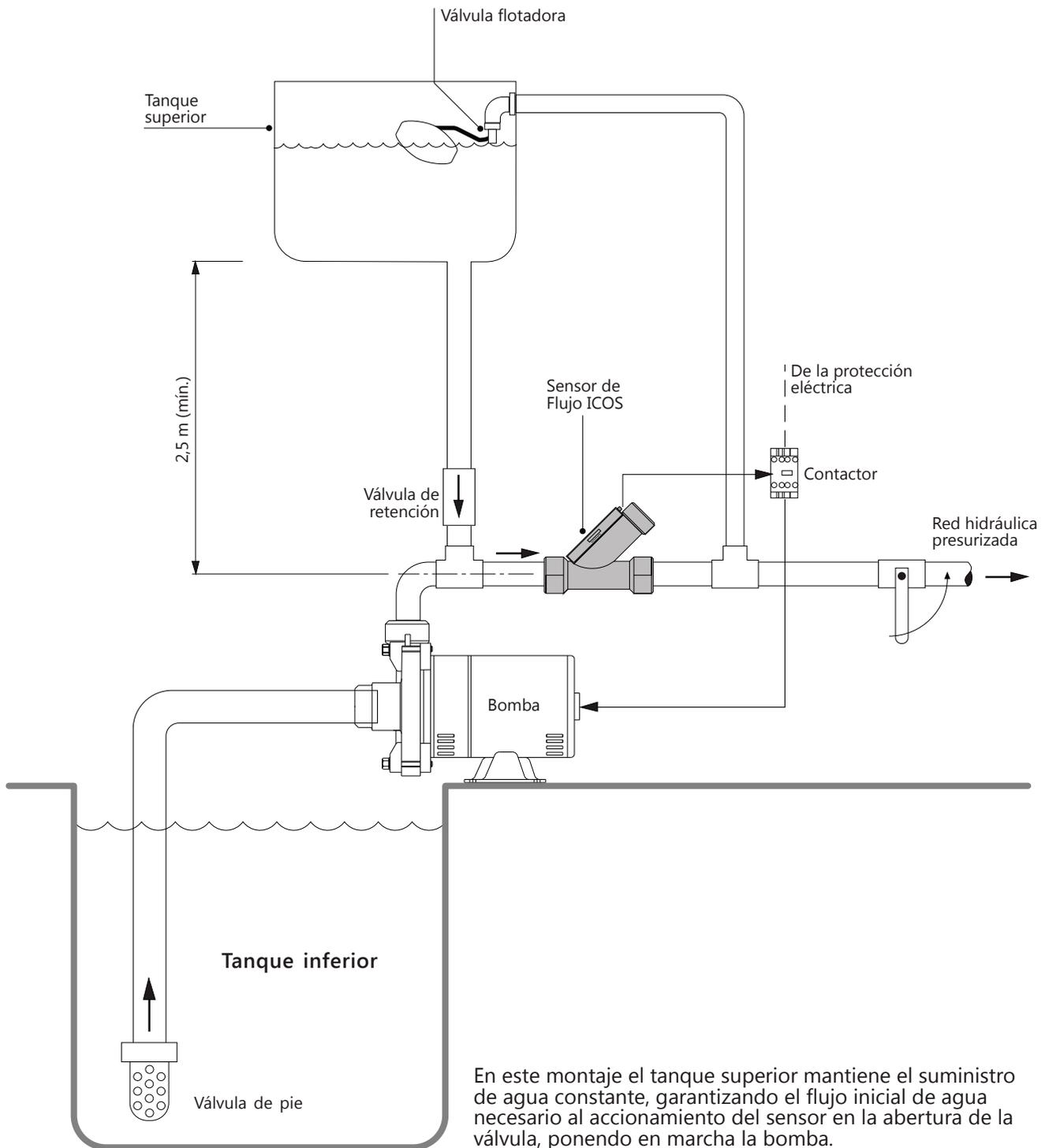
En este montaje el tanque superior mantiene el suministro de agua constante, garantizando el flujo inicial de agua necesario al accionamiento del sensor en la abertura de la válvula, poniendo en marcha la bomba.
